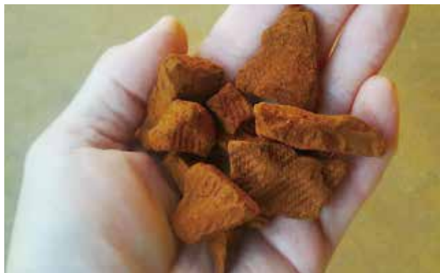
ステンレス汚泥(脱水後)
