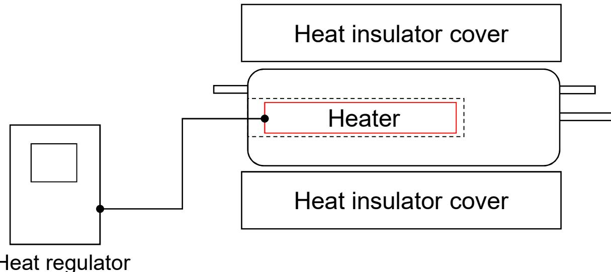
専用ヒーターはモジュール本体に差し込んで設置します。
