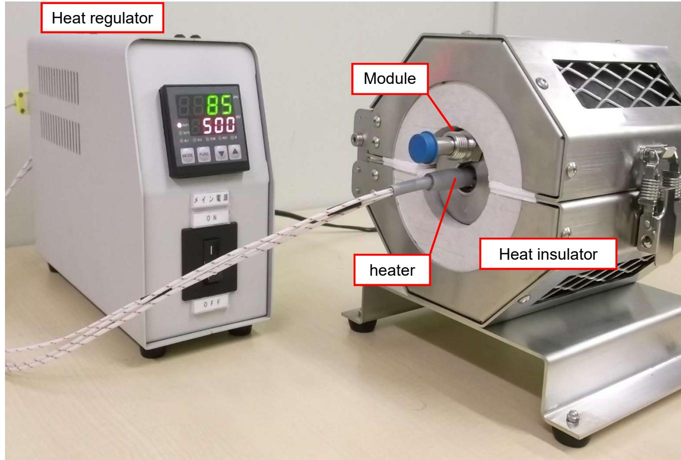
構成 : モジュール(HS12F01) カートリッジヒーター 断熱ケース 温度コントローラー
