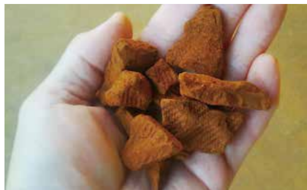
ステンレス汚泥(脱水後)
