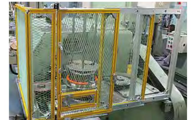
回転物巻き込まれ防止事例（安全カバーの設置）
