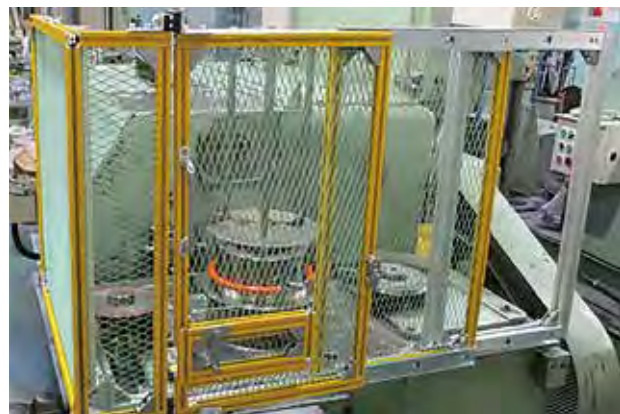
回転物巻き込まれ防止事例(安全カバーの設置)
