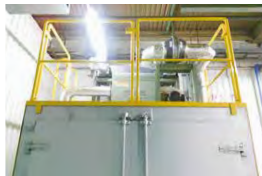
ナスロンフィルターの乾燥処理工程における排熱回収イメージ図
