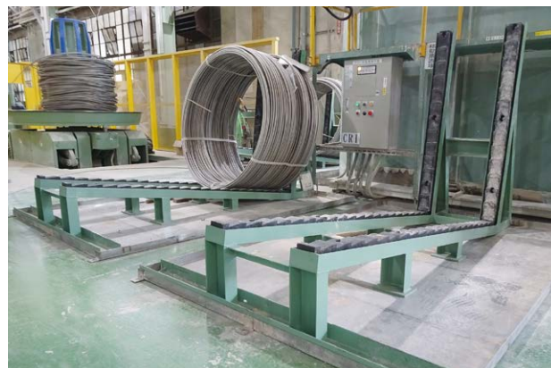
材料立て掛け台の改善事例(材料転倒防止対策)
