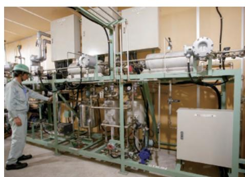
水素貯蔵回収モジュールの実験装置
