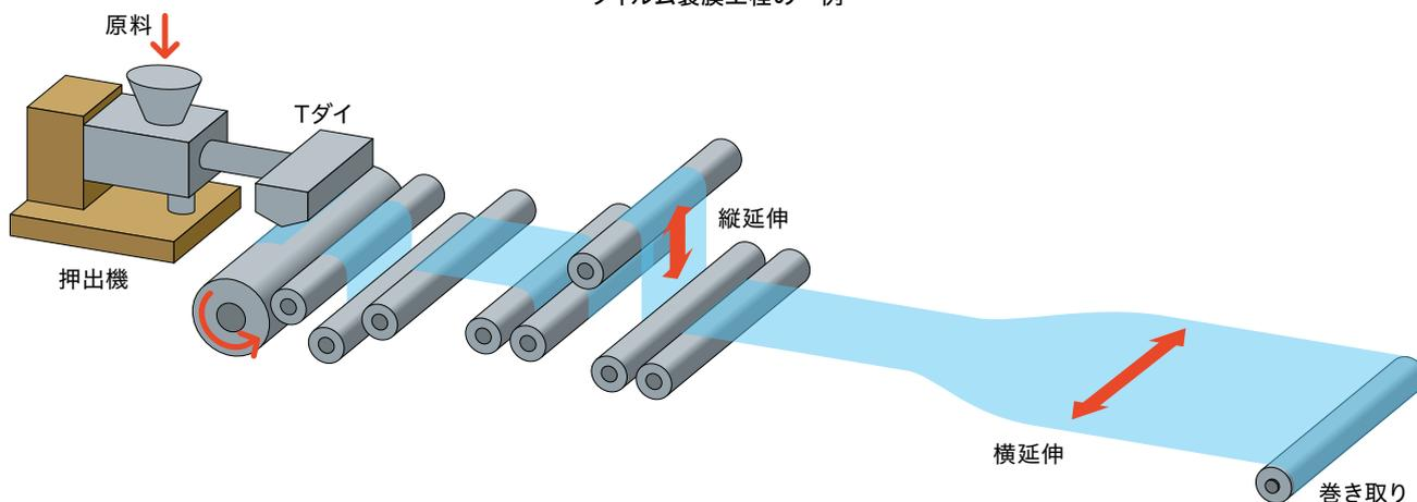
セパレータフィルムは、溶融した樹脂の異物を除去しながら薄いフィルムに形成(製膜)し、その後延伸し開孔して製造されます。電池を高容量化するためには、フィルムを薄膜化する必要があり高度な製膜技術が必要です。
