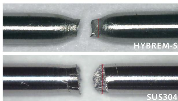
低温SSRT試験後の破断部
