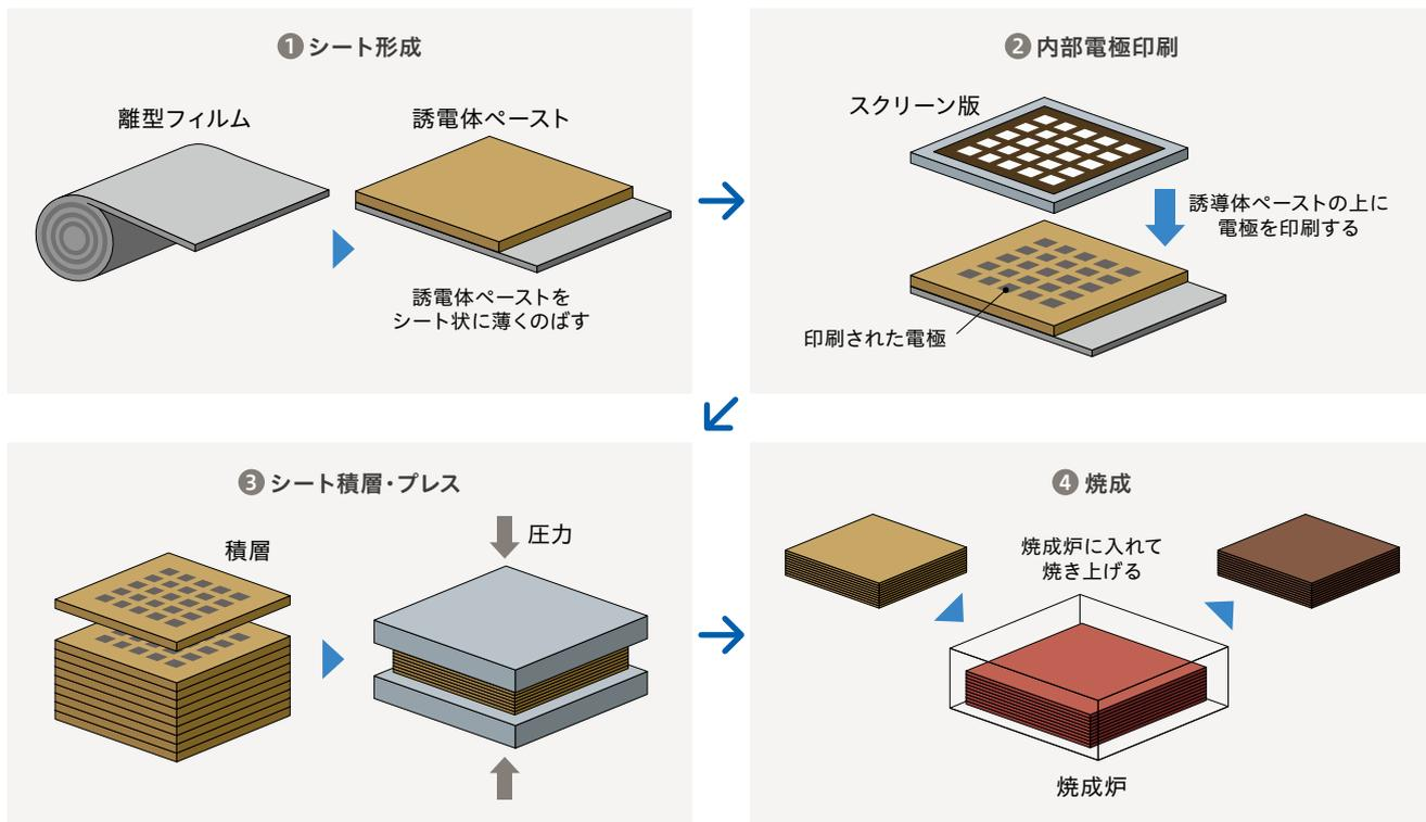
MLCCの製造は、誘電体ペーストを離型フィルム上に薄く塗布し、そのペーストの上に電極を印刷します。
