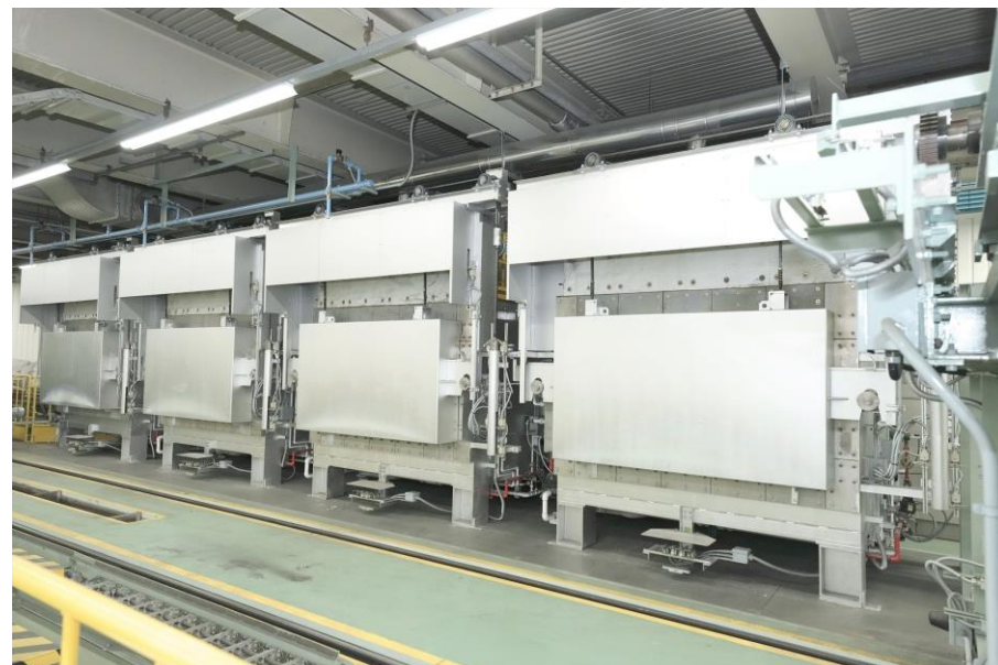
ナスロンフィルター用省エネハイブリッド型熱処理炉 2023年4月稼働
