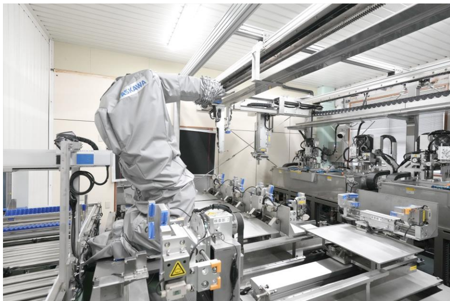
リーフディスク型フィルター用自動超音波洗浄装置 2022年12月稼働
